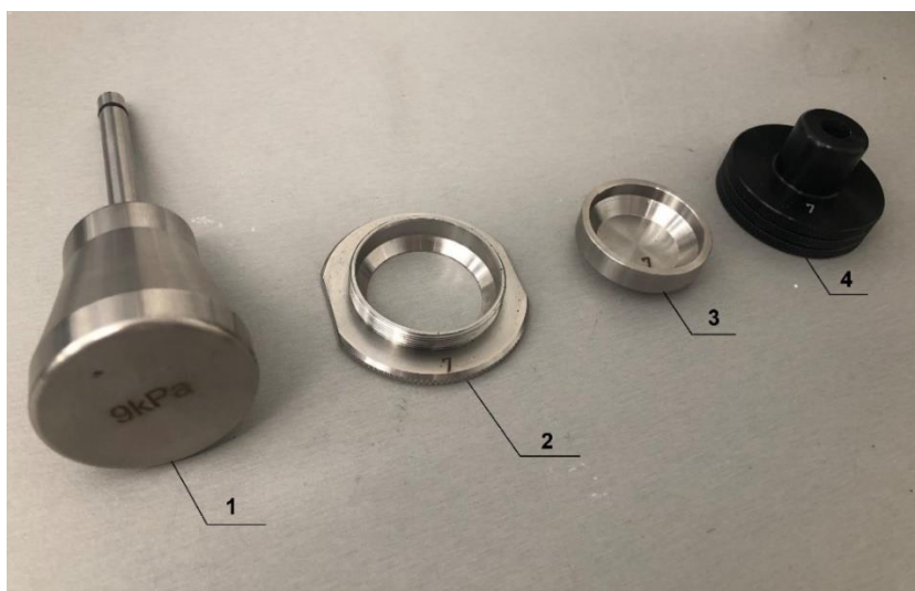
Rys. 4.13. Elementy składowe mocowania próbek: 1 – obciążenie, 2 – nakrętka uchwyty próbki, 3 – wkładka uchwyty próbki, 4 – oprawa uchwyty [opracowanie własne]
