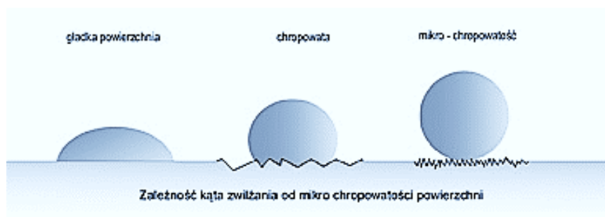
Rys. 2.42. Zwilżalność powierzchni o różnej chropowatości [72]
