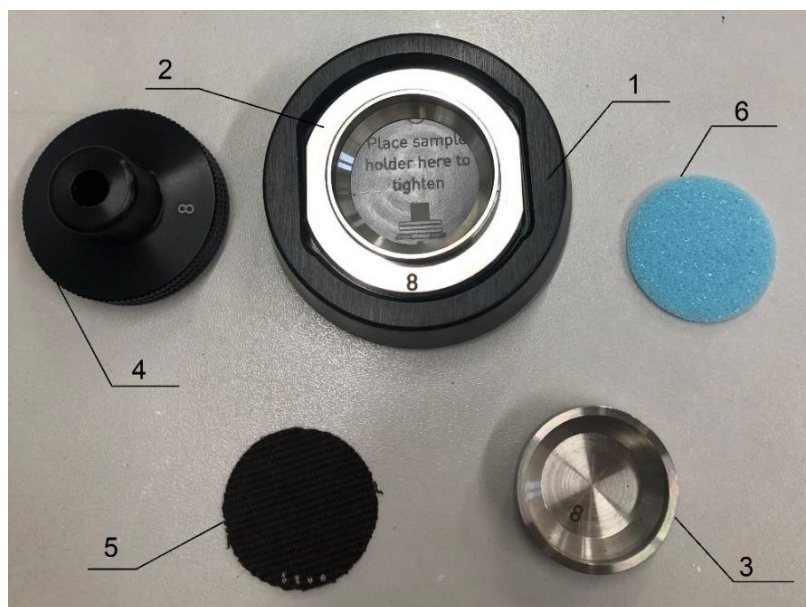
Rys. 4.12. Elementy składowe mocowania próbek: 1 – urządzenie do mocowania próbek, 2 – nakrętka uchwyty próbki, 3 – wkładka uchwyty próbki, 4 – oprawa uchwyty, 5 – próbka robocza, 6 – podkładka z pianki [opracowanie własne]
