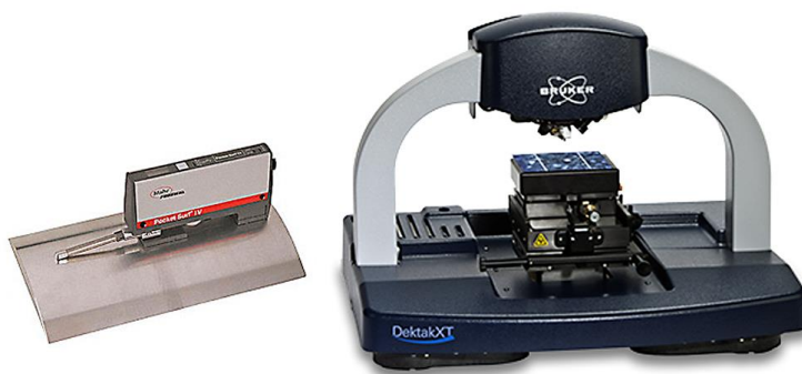
Rys. 2.9. Przykładowe instrumenty rysikowe do pomiaru mikrogeometrii powierzchni metodą kontaktową; Źródło: https://michmet.com/average-roughness-basics/
