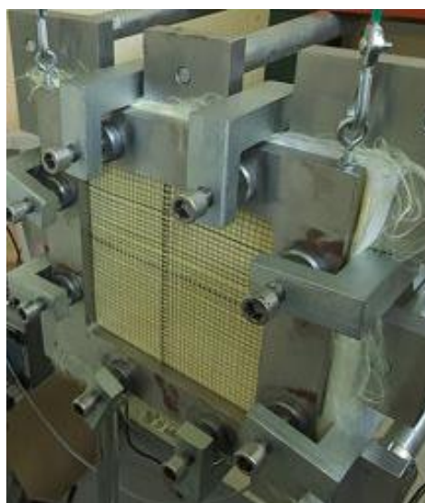
Rys. 86. Widok pakietu balistycznego zamocowanego w ramach stalowych
