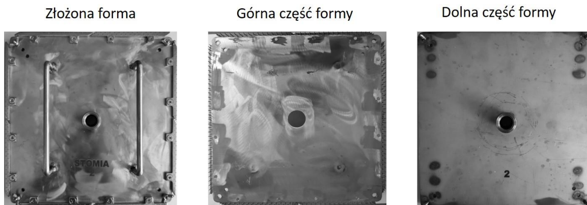
Rysunek 21 Forma do stabilizacji termicznej siatki chirurgicznej do operacyjnego leczenia przepuklin okołostomijnych.
