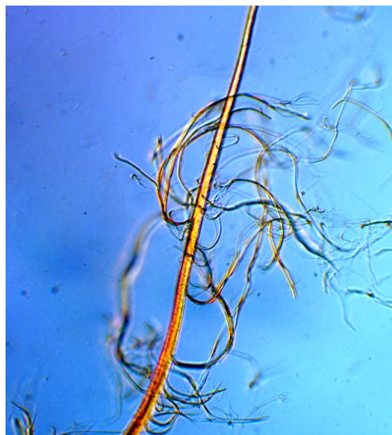
Rys. 26. Widok włókna Lyocell A - niesfibrylowanego, B - sfibrylowanego w trakcie procesu mielenia w młynku PFI. Obraz w świetle spolaryzowanym, powiększenie 100x
