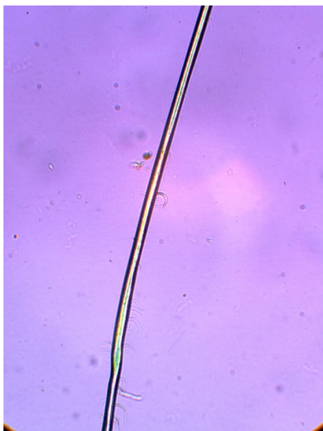
Rys. 26. Widok włókna Lyocell A - niesfibrylowanego, B - sfibrylowanego w trakcie procesu mielenia w młynku PFI. Obraz w świetle spolaryzowanym, powiększenie 100x
