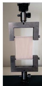
Rysunek 4.2.2. Dżianina w formie opaski zamocowana w uchwytych 191 wykorzystywanych w metodzie rozciągania w pętli (opracowanie własne)
