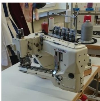
Rysunek 3.1.3.2. Stanowisko łączenia elementów – 4-igłowa maszyna Autolap (opracowanie własne)
