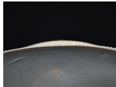
Rys.2.6.2.4. Widok wyoblania wzdłuż krzywizny cylindra (opracowanie własne)
