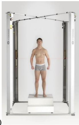
Rysunek 4.3.1. Widok a) komputerowego stanowiska operacyjnego skanera, służącego do rejestracji, archiwizacji i analizy danych pomiarowych (rys. własnego autorstwa) oraz b) widok wnętrza kabiny wyposażonej w 4 skanery oraz wzorcową sylwetkę 227
