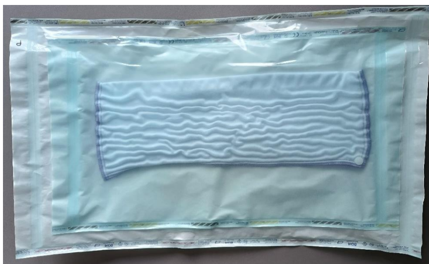
Rysunek 40. Pomarszczony materiał po procesie sterylizacji parą wodną.
