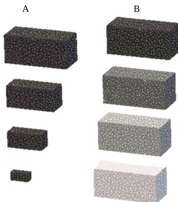
Rysunek 12. Erozja powierzchniowa (A) i objętościowa (B) [123]
