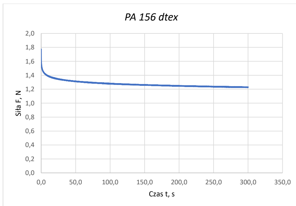
Rys. 11.3.8 Wykres uśrednionej wartości sił podczas relaksacji naprężeń w nitkach poddanych procesowi rozciągania: przędza poliamidowa PA 156 dtex, długość rozciąganego odcinka l = 1000\text{mm} , wydłużenie \Delta l = 20\text{ mm} Źródło: opracowanie własne
