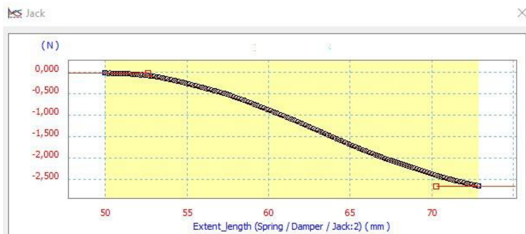
Rys. 12.2.8 Okno dialogowego członu S1 – widok wykresu z wprowadzonymi wartościami siły F = f(\Delta l) otrzymanymi podczas dynamicznego rozciągania, dane dla wariantu PES111-20ms-200mm
