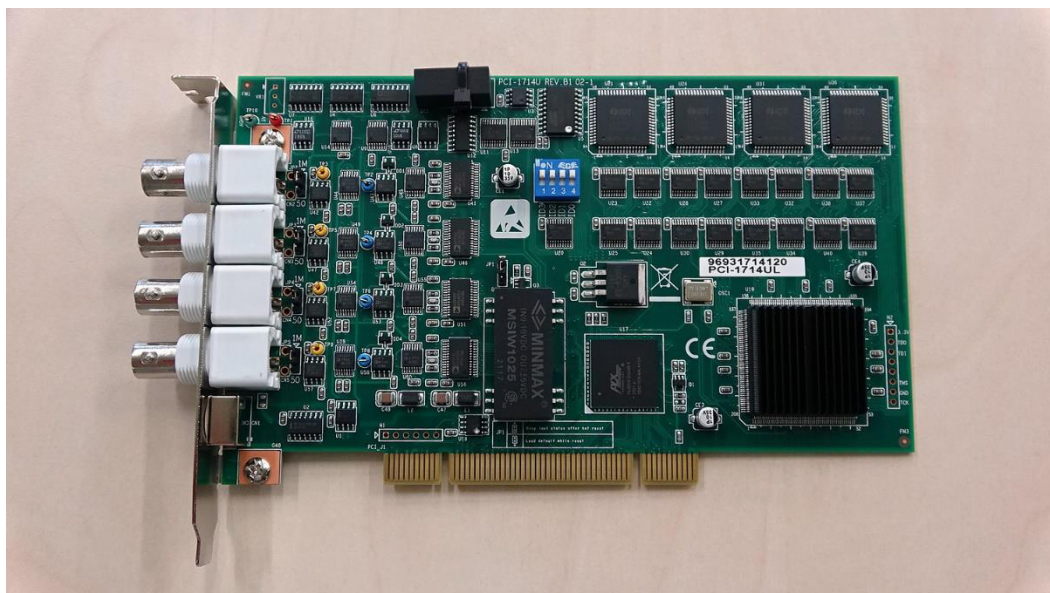
Rys. 5.3.2.1 Karta pomiarowa transmisji analogowo - cyfrowej PCI-1714UL firmy Advantech Źródło: opracowanie własne
