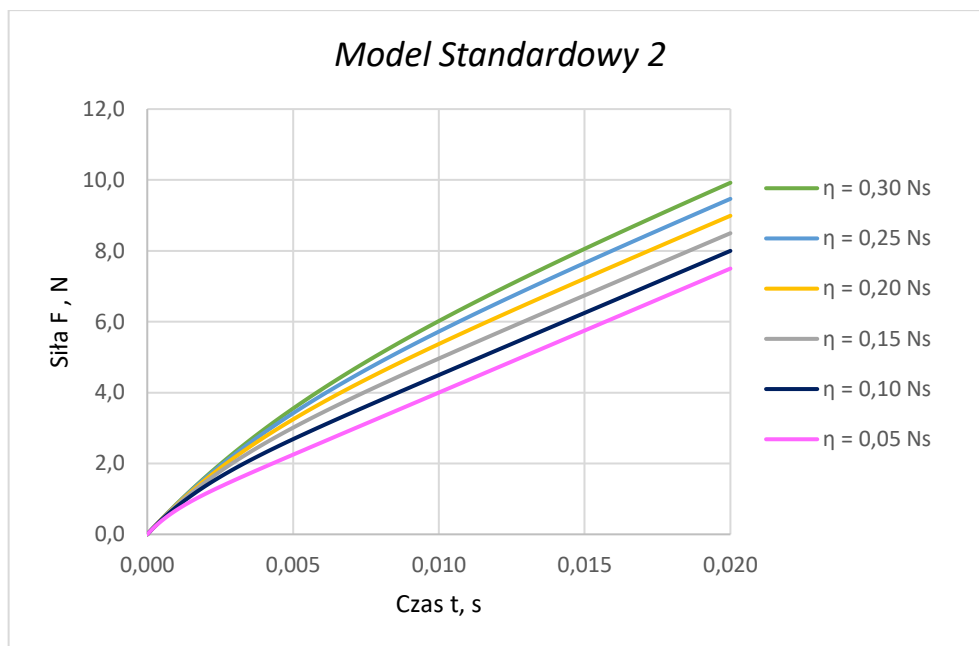
Rys. 9.2.1 Charakterystyki F = f(t) modelu Standardowego 2 dla współczynnika lepkości \eta = 0,05 \div 0,30 \text{ Ns} i prędkości przyrostu wydłużenia względnego \omega = 10 \text{ 1/s} Źródło: opracowanie własne
