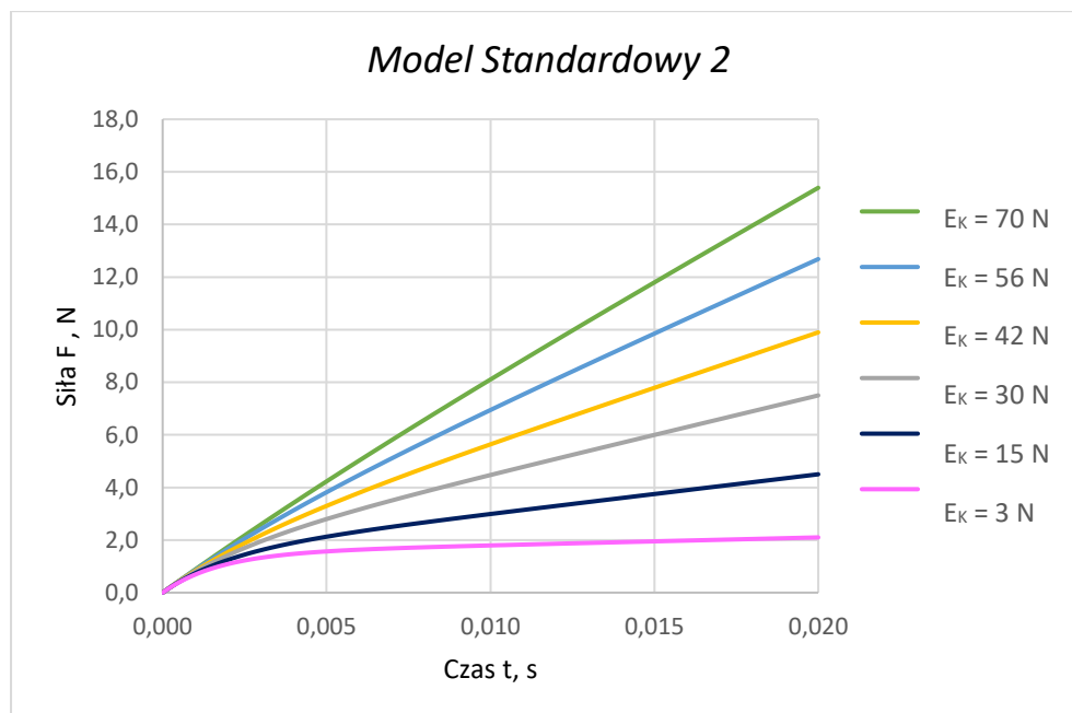
Rys. 9.2.3 Charakterystyki F = f(t) modelu Standardowego 2 dla współczynnika sprężystości podczas kinematycznego wymuszenia E_K = 3 \div 70 N i prędkości przyrostu wydłużenia względnego \omega = 10 1/s
