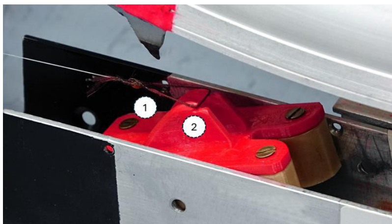
Rys. 5.1.2 Widok rzeczywisty przedstawiający zaczepek z umieszczonym zaciskiem ruchomym w postaci pętli wykonanej z nici szwalniczej: 1 – pętla umocowana na jednym z końców badanej przędzy, 2 – zaczepek
