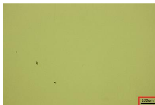
Rys. 2.36 Obraz mikroskopowy dla wodnego ekstraktu po 21 dniach hydrolizy włókniny igłowanej z PBS
