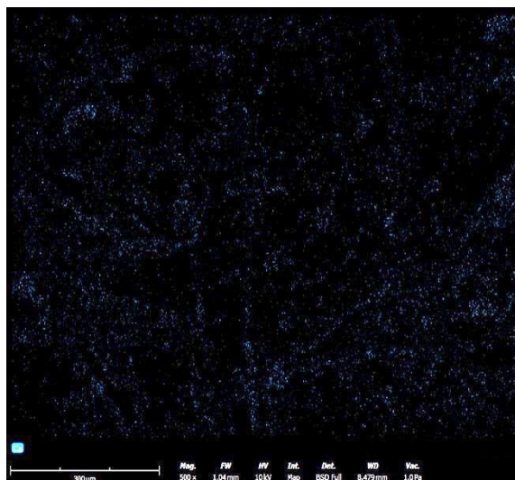
Rys. 4.43 Zdjęcie SEM-EDS z zaznaczonym wapniem (Ca) dla włókniny igłowanej z PBS z 15% \text{CaCO}_3
