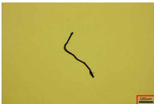
Rys. 2.39 Obraz mikroskopowy dla wodnego ekstraktu po 60 dniach hydrolizy włókniny igłowanej z PLA
