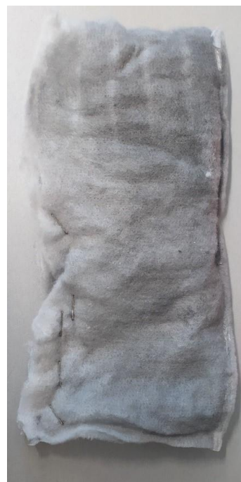
Rys. 6.7 Włóknina igłowana z PLA + węgiel aktywny po 24 godz. zanurzeniu w roztworze wodnym zawierającym jony Pb^{2+}
