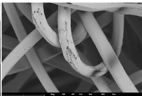
Rys. 2.21 Zdjęcie SEM dla włókniny igłowanej z PBS po 21 dniach hydrolizy
