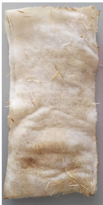
Rys. 6.8 Włóknina igłowana z PBS + słoma owsiana po 24 godz. zanurzeniu w roztworze wodnym zawierającym jony Pb^{2+}
