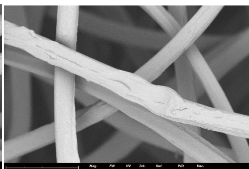
Rys. 2.29 Zdjęcie SEM dla włókniny igłowanej z PBS po 120 dniach hydrolizy
