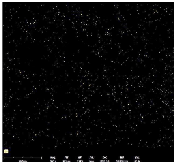
Rys. 7.45 Zdjęcie SEM-EDS z zaznaczonym cynkiem (Zn) dla włókniny igłowanej z PBS + 4,5% ZnS
