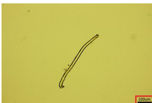
Rys. 2.35 Obraz mikroskopowy dla wodnego ekstraktu po 21 dniach hydrolizy włókniny igłowanej z PLA
