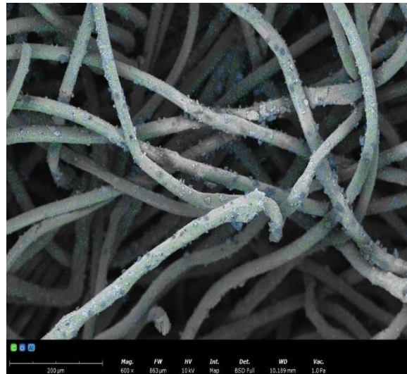
Rys. 5.25 Zdjęcie SEM-EDS z zaznaczonymi pierwiastkami (C, O, Al) dla włókniny igłowanej z PLA z 15% \text{Al}_2\text{O}_3
