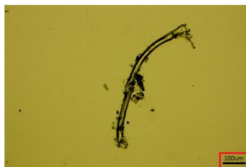
Rys. 2.44 Obraz mikroskopowy dla wodnego ekstraktu po 120 dniach hydrolizy włókniny igłowanej z PBS
