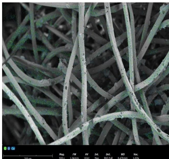
Rys. 4.40 Zdjęcie SEM-EDS z zaznaczonymi pierwiastkami (C, O, Ca) dla włókniny igłowanej z PBS z 15% \text{CaCO}_3
