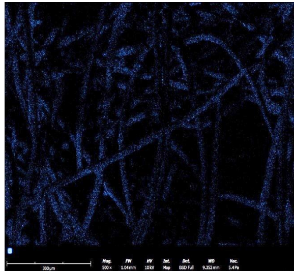
Rys. 5.32 Zdjęcie SEM-EDS z zaznaczonym tlenem (O) dla włókniny igłowanej z PLA z 15% Cloisite – 116
