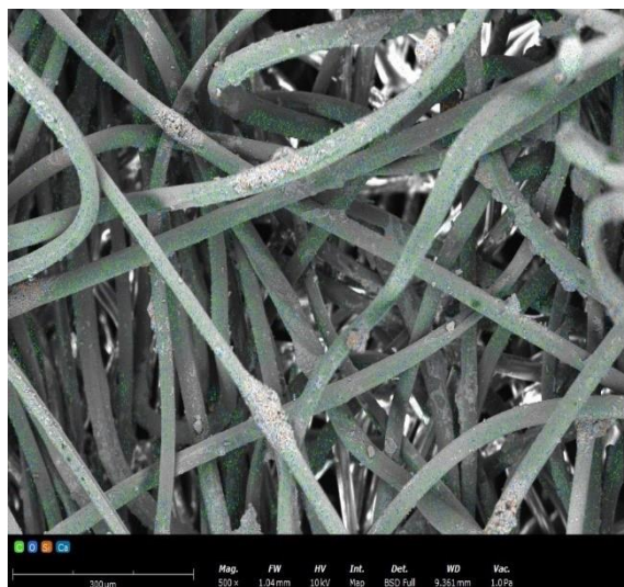
Rys. 4.45 Zdjęcie SEM-EDS z zaznaczonymi pierwiastkami (C, O, Si, Ca) dla włókniny igłowanej z PBS z 15% Polonite®
