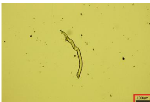
Rys. 2.37 Obraz mikroskopowy dla wodnego ekstraktu po 45 dniach hydrolizy włókniny igłowanej z PLA
