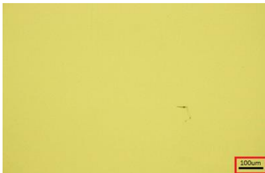
Rys. 2.93 Obraz mikroskopowy dla wodnego ekstraktu po 90 dniach hydrolizy włókniny spunbond z PLA
