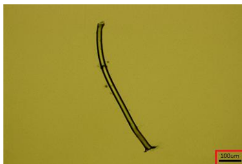
Rys. 2.42 Obraz mikroskopowy dla wodnego ekstraktu po 90 dniach hydrolizy włókniny igłowanej z PBS
