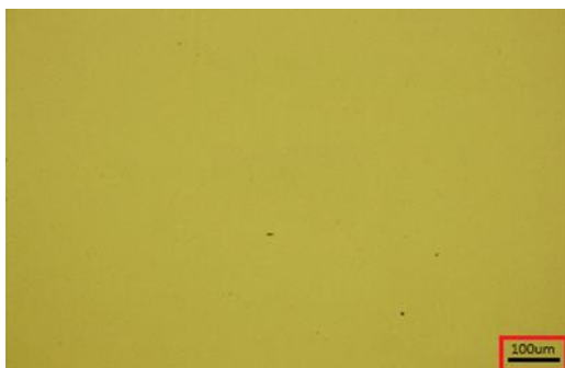
Rys. 2.89 Obraz mikroskopowy dla wodnego ekstraktu po 45 dniach hydrolizy włókniny spunbond z PLA
