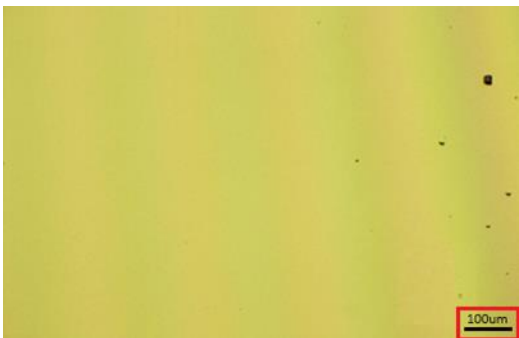
Rys. 2.86 Obraz mikroskopowy dla wodnego ekstraktu po 7 dniach hydrolizy włókniny igłowanej z PBS
