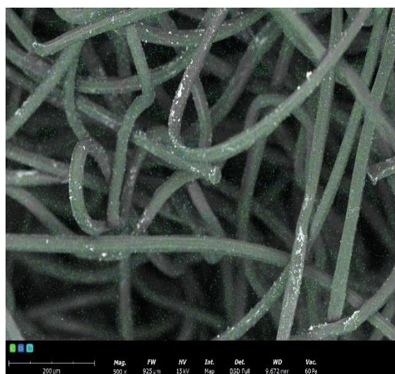
Rys. 7.52 Zdjęcie SEM-EDS z zaznaczonymi pierwiastkami (C, O, Ti) dla włókniny igłowanej z PLA+ 4,5% TiO 2
