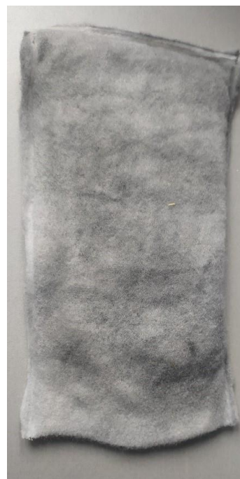
Rys. 6.10 Włóknina igłowana z PBS + węgiel aktywny po 24 godz. zanurzeniu w roztworze wodnym zawierającym jony Pb^{2+}
