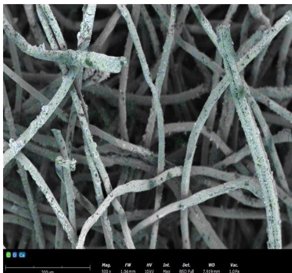
Rys. 4.29 Zdjęcie SEM-EDS z zaznaczonymi pierwiastkami (C, O, Ca) dla włókniiny igłowanej z PLA z 15% \text{CaCO}_3
