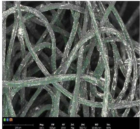
Rys. 7.47 Zdjęcie SEM-EDS z zaznaczonymi pierwiastkami (C, O, Ag) dla włókнины igłowanej z PLA+ 4,5% nano-Ag
