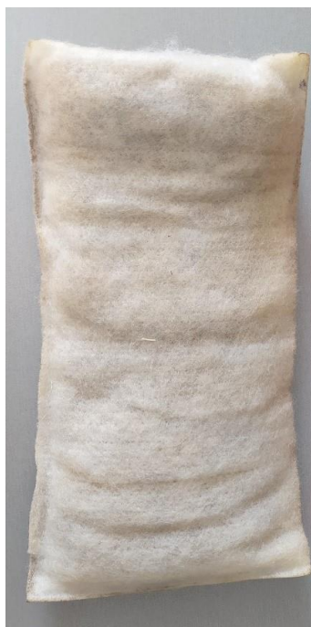
Rys. 6.6 Włóknina igłowana z PLA + paździerz konopny po 24 godz. zanurzeniu w roztworze wodnym zawierającym jony Pb^{2+}
