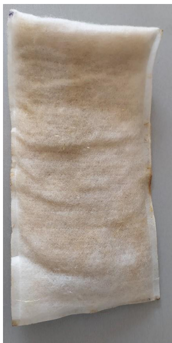
Rys. 6.5 Włóknina igłowana z PLA + słoma owsiana po 24 godz. zanurzeniu w roztworze wodnym zawierającym jony Pb^{2+}
