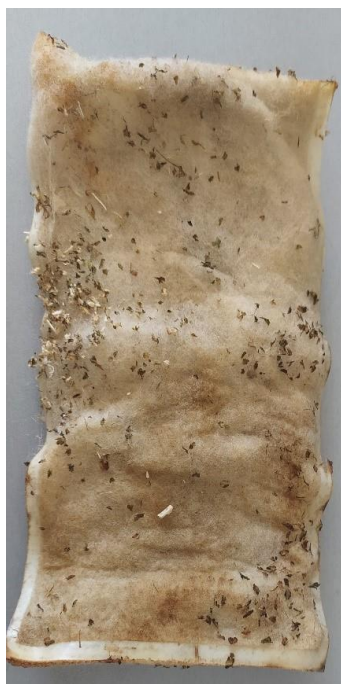
Rys. 6.9 Włóknina igłowana z PBS + paździerz konopny po 24 godz. zanurzeniu w roztworze wodnym zawierającym jony Pb^{2+}
