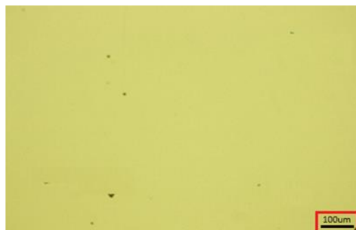
Rys. 2.96 Obraz mikroskopowy dla wodnego ekstraktu po 120 dniach hydrolizy włókniny spunbond z PBS
