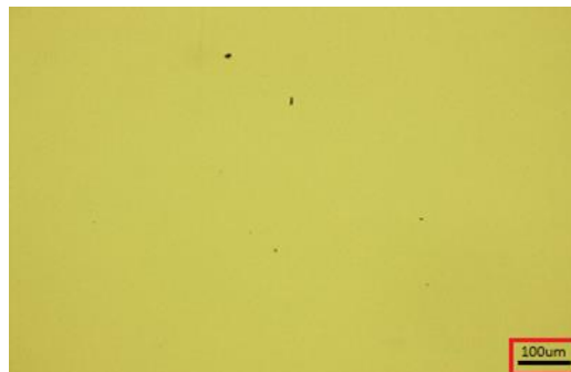
Rys. 2.88 Obraz mikroskopowy dla wodnego ekstraktu po 21 dniach hydrolizy włókniny spunbond z PBS
