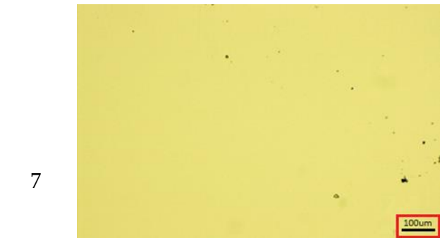
Rys. 2.85 Obraz mikroskopowy dla wodnego ekstraktu po 7 dniach hydrolizy włókniny spunbond z PLA
