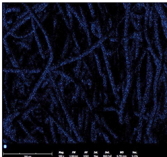
Rys. 4.36 Zdjęcie SEM-EDS z zaznaczonym tlenem (O) dla włókniny igłowanej z PLA z 15% Polonite®
