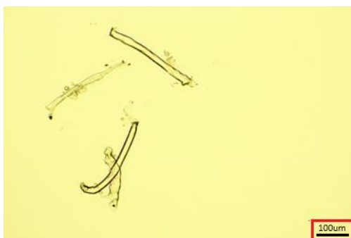
Rys. 2.41 Obraz mikroskopowy dla wodnego ekstraktu po 90 dniach hydrolizy włókniny igłowanej z PLA
