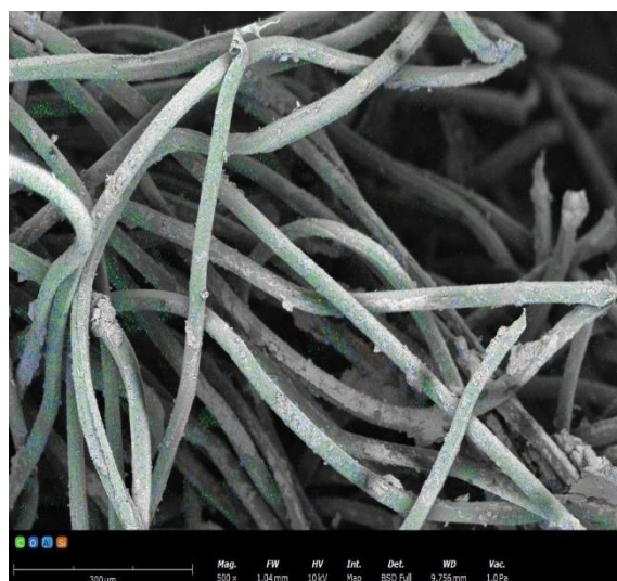
Rys. 5.41 Zdjęcie SEM-EDS z zaznaczonymi pierwiastkami (C, O, Al, Si) dla włókniny igławanej z PBS z 15% Cloisite – 116
