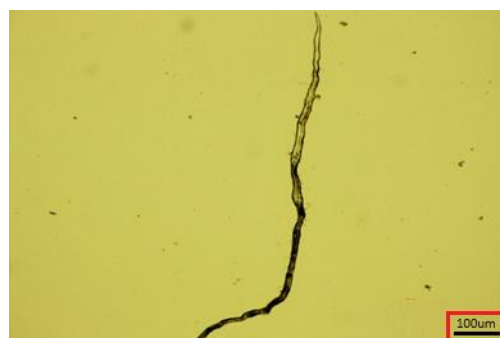
Rys. 2.38 Obraz mikroskopowy dla wodnego ekstraktu po 45 dniach hydrolizy włókniny igłowanej z PBS
