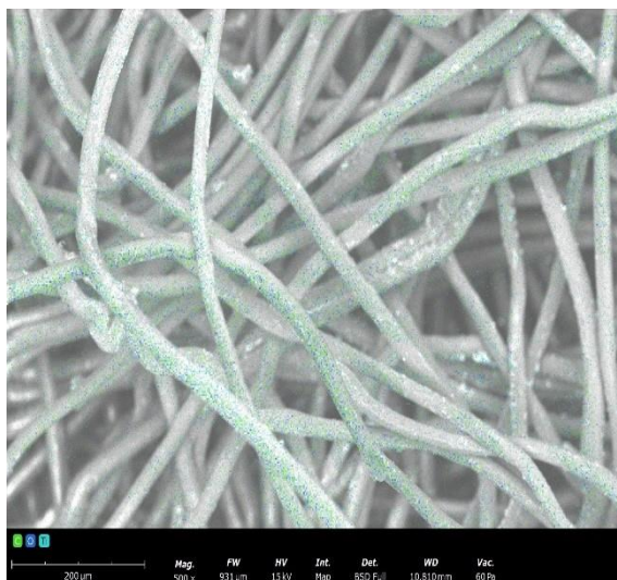
Rys. 7.37 Zdjęcie SEM-EDS z zaznaczonymi pierwiastkami (C, O, Ti) dla włókniny igłowanej z PLA+ 4,5% TiO 2
