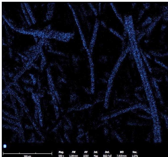
Rys. 4.31 Zdjęcie SEM-EDS z zaznaczonym tlenem (O) dla włókniiny igłowanej z PLA z 15% \text{CaCO}_3
