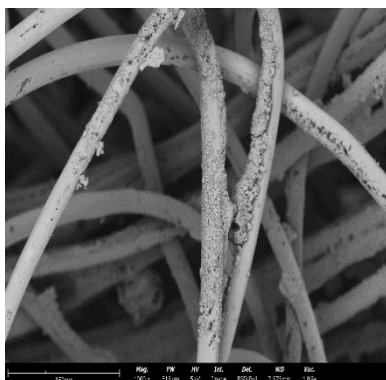
Rys. 4.19 Zdjęcie SEM dla włókniny igłowanej z PLA z 10% Polonite®
