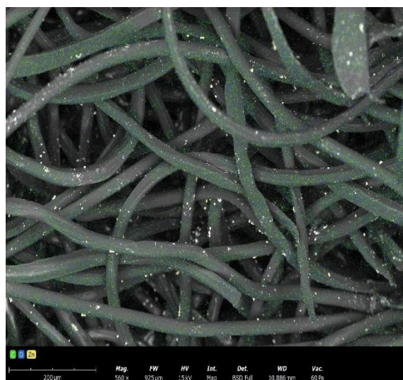
Rys. 7.42 Zdjęcie SEM-EDS z zaznaczonymi pierwiastkami (C, O, Zn) dla włókniny igłowanej z PBS + 4,5% ZnS
