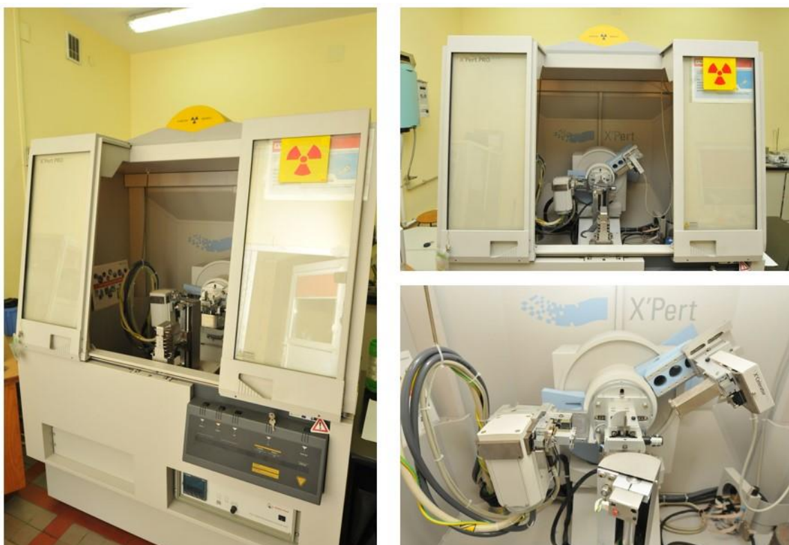
Rysunek 32. Szerokokątowy dyfraktometr rentgenowski X'Pert Pro PANalytical (Holandia).
