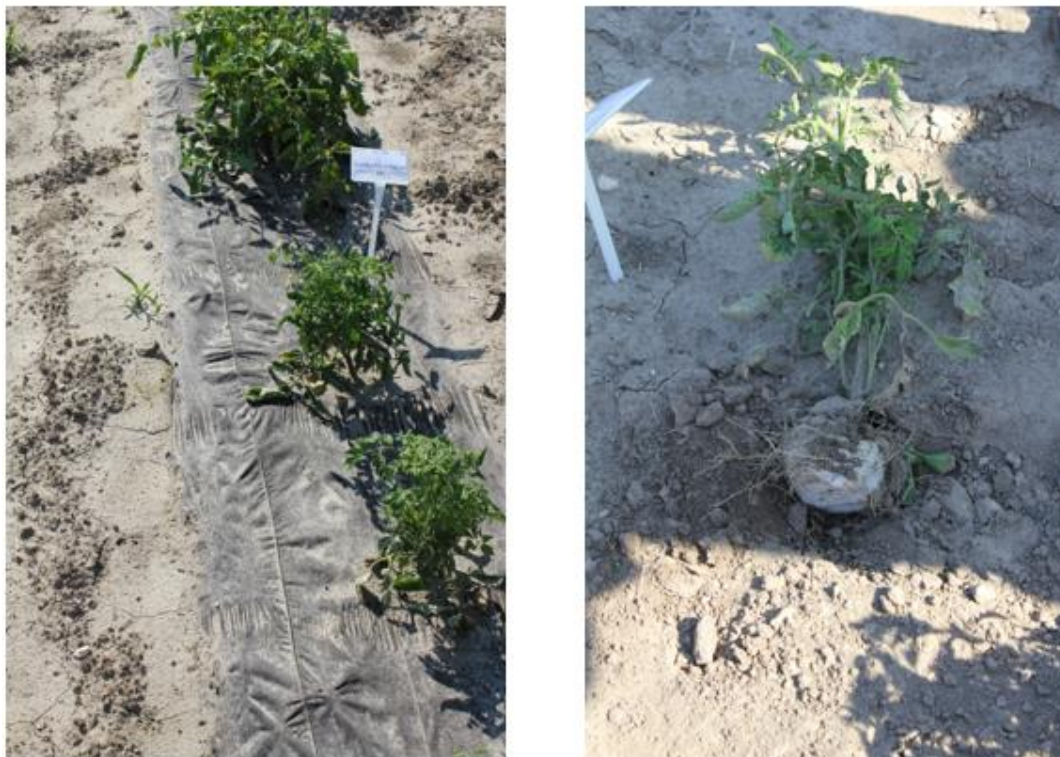
Rysunek 11. Przykłady materiałów zastosowanych w projekcie "Biogratex". Po lewej włóknina ściółkowa z PLA, po prawej doniczka z włókniny PBS.
