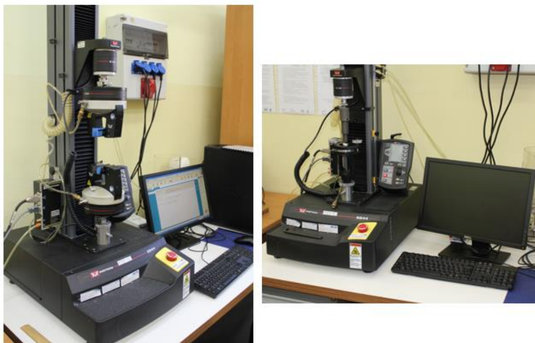
Rysunek 28. Maszyna wytrzymałościowa Instron 5544 (USA), po lewej przystosowana do badania wytrzymałości na rozciąganie, po prawej przystosowana do badania wytrzymałości na przebicie kulką.
