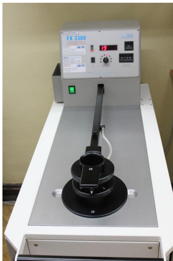
Rysunek 27 Urządzenie do pomiaru przepuszczalności powietrza - Textest FX 3300-II (Szwajcaria).
