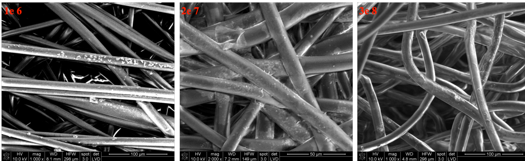
Rysunek 36. Obrazy SEM włóknin poddanych kompleksowaniu (układ PDMAEMA+ ZnSO_4 \cdot 7H_2O ), powiększenie 1000x 1e6 – Włóknina PLA modyfikowana PDMAEMA + ZnSO_4 \cdot 7H_2O , 2e7 - Włóknina PLA modyfikowana PDMAEMA + Zn SO_4 \cdot 7H_2O , 3e8 - Włóknina PP modyfikowana PDMAEMA+ ZnSO_4 \cdot 7H_2O
