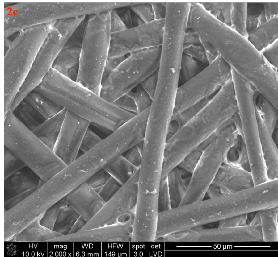
Rysunek 45. Obrazy SEM włóknin poddanych kompleksowaniu 2c - Włóknina PLA (układ PDMAEMA + FeSO_4 \cdot 7H_2O ), powiększenie 2000x
