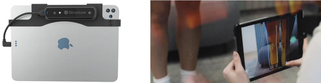
Rys. 10. Mobilny skaner 3D Structure Sensor III oraz proces skanowania kończyny dolnej [50], [51]
