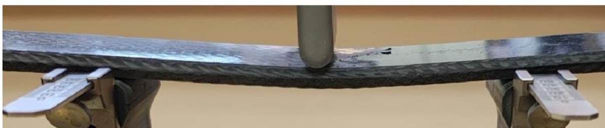
Rys. 55. Kompozyt MLC podczas próby zginania
