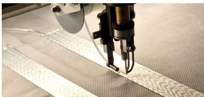
Rys. 40. Proces haftowania technicznego (TFP, z ang. tailored fiber placement) jednokierunkowo ułożonych wzmocnień włókienniczych z włókna szklanego
