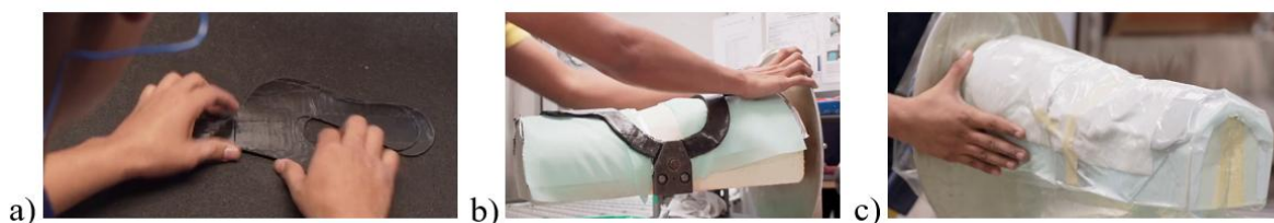
Rys. 12. Etapy formowania ramy ortozy stawu kolanowego CTi firmy Össur: a) układanie prepregów z włókna węglowego, b) nakładanie prepregów na formę, c) utwardzanie w warunkach próżniowych [60]
