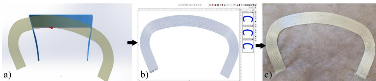
Rys. 64. Proces projektowania i wytwarzania wzmocnienia włókienniczego metodą haftu technicznego (TFP): a) płaskie rozwinięcie powierzchni, b) program haftu technicznego, c) gotowe wzmocnienie włókiennicze
