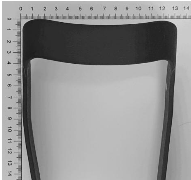
Rys. 30. Przestrzenny rdzeń drukowany w technologii druku 3D odwzorowujący kształt ramy ortozy
