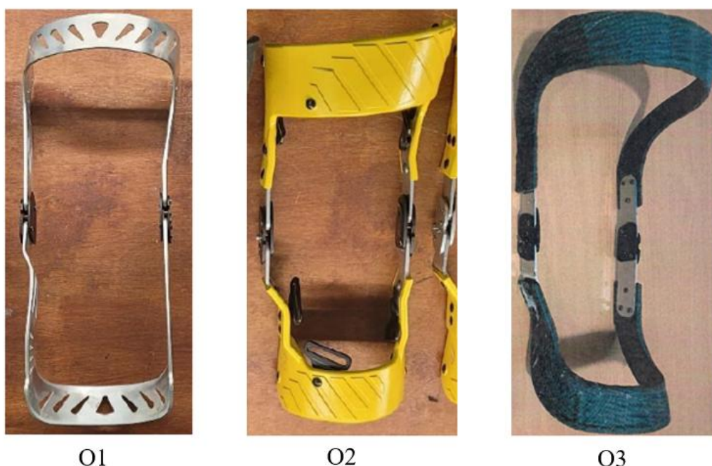
Rys. 74. Ortezy stawu kolanowego przeznaczone do testów czteropunktowego zginania. Materiał: O1 - aluminium EN AW 2017 T4, O2 - druk 3D PA11 CF (PBF), O3 - kompozyt MLC
