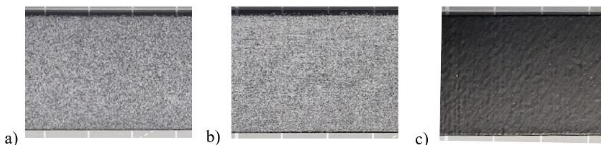
Rys. 36. Modyfikacje powierzchni elementów drukowanych 3D metodą spiekania proszku (PBF): a) piaskowanie, b) obróbka wibrościerna, c) wygładzanie chemiczne
