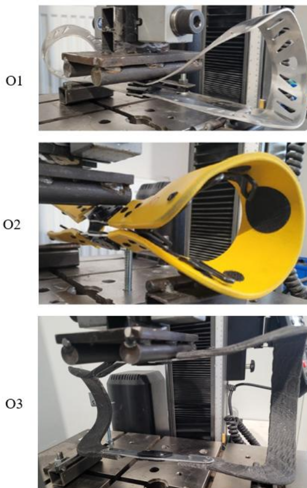
Rys. 75. Czteropunktowe zginanie ortez w płaszczyźnie czołowej. Materiał: O1 - aluminium EN AW 2017 T4, O2 - druk 3D PA11 CF (PBF), O3 - kompozyt MLC [200]
