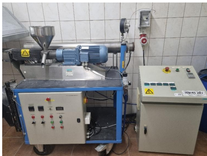
Rysunek 6.2.1. Wyłaczarka laboratoryjna firmy AXON wykorzystana w pracach do wytwarzania włókien typu melt-blown .
