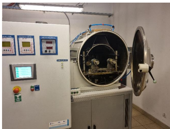
Rysunek 6.2.2. Magnetron – prototypowe urządzenie do napyłania magnetronowego (DC) wytworzone we współpracy Instytutu z firmą P.P.H. Jolex sc., wykorzystane w pracach badawczych.
