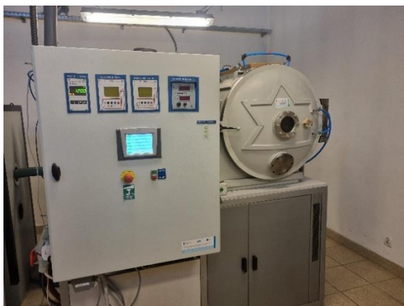
Rysunek 6.2.2. Magnetron – prototypowe urządzenie do napyłania magnetronowego (DC) wytworzone we współpracy Instytutu z firmą P.P.H. Jolex sc., wykorzystane w pracach badawczych.
